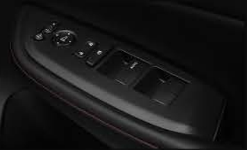
Door Switch Panel
